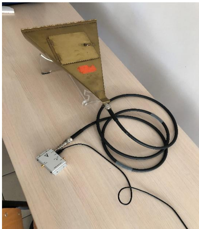
Slika 3. Gigahercna transverzalna elektromagnetska (HCTEM) komora.
