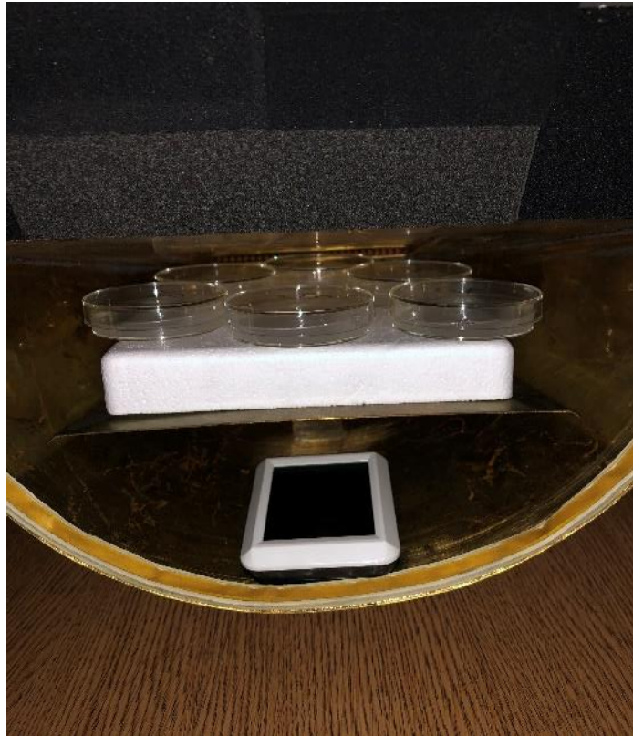
Slika 5. Prikaz Petrijevih zdjelica unutar komore sa digitalnim termometrom.
