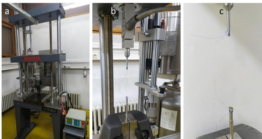
Slika 7. Prikaz kidalice Beta 50-5 (a) te postavljanje niti šivaćeg materijala na prihvat kidalice (b) i pravilan način pucanja niti (c).
